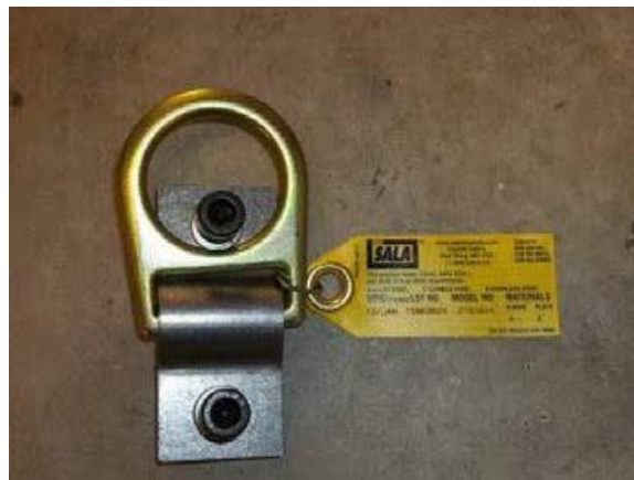
圖6 帶兩個錨栓的D形環錨定板 使用 1/2” -13 TPI UNC 1-1/2” 長的 8 級內六角圓柱頭螺絲和鎖緊墊圈（將扭矩緊固至 40 英尺磅）連接
