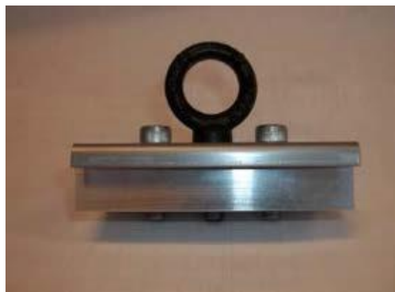
圖6 帶兩個錨栓的D形環錨定板 使用 1/2” -13 TPI UNC 1-1/2” 長的 8 級內六角圓柱頭螺絲和鎖緊墊圈（將扭矩緊固至 40 英尺磅）連接
